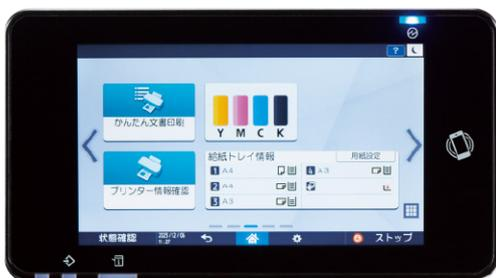
静電容量式により操作性を高めた7インチフルカラータッチパネル「MultiLink-Panel」を搭載。フリックやドラッグなどの直感的な画面操作ができ、快適にお使いいただけます。各種アプリケーションも画面から簡単に設定できるため、業務効率が向上します。
