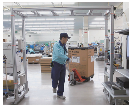
「改良型包装材」のタグを一括読み取りするアンテナゲート
