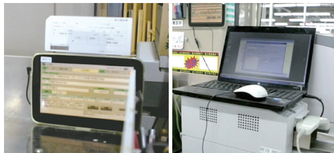
リライタブルハイブリッドメディアを読み取るタブレットが各作業場にセットされている。
