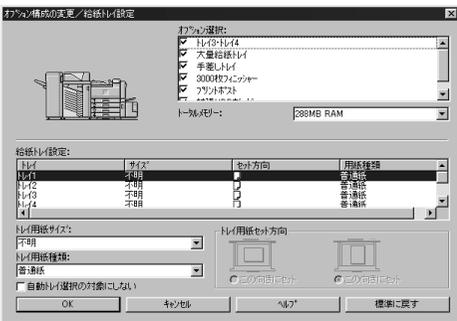
**6** [ 給紙トレイ設定 ] で、設定するトレイをクリックして反転表示させ、[ トレイ用紙サイズ ]・[ トレイ用紙セット方向 ]・[ トレイ用紙種類 ] を正しく設定します。
