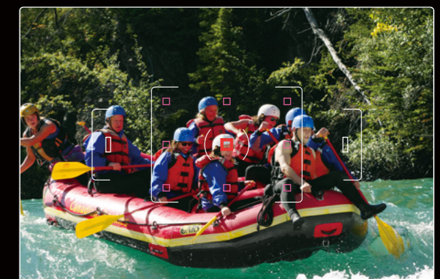
たとえば中央1点をセレクト時は、周辺8点が捕捉をサポート。利用される測距点はステータス画面にピンクで表示されます。
