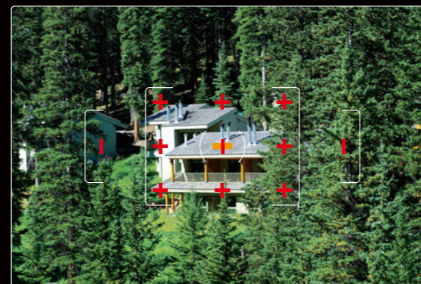
+ クロスセンサー — F2.8光束ラインセンサー | ラインセンサー ※測距点の選択は「オート/セレクト/中央」を用意しています。
