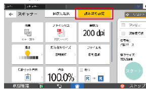
「読み取り設定」タブを押すと、カラーやファイル形式、解像度など細かい設定が可能。また、プレビューにチェックすれば、スキャン蓄積前に画像の確認ができます。
