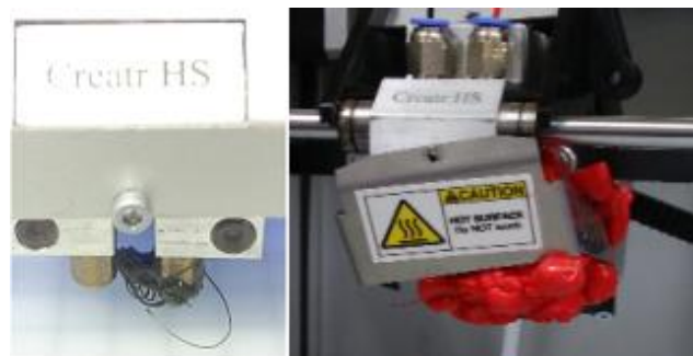
写真1：ノズルに樹脂がまとわり付いてくる
