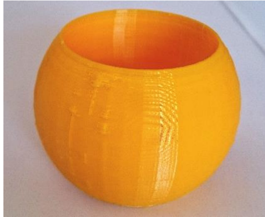
写真2： 積層ピッチ 0.15mm で造形した直径 6cm の器
