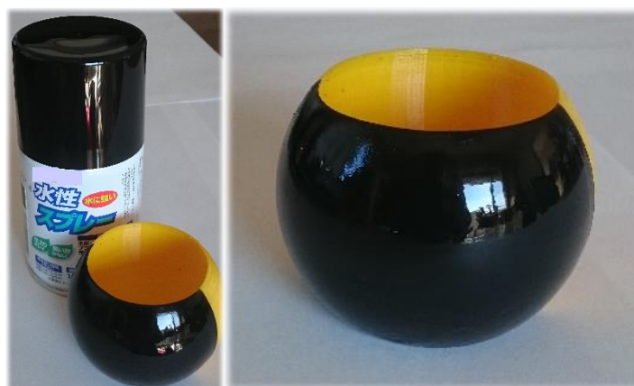
写真7： マスキングを外して完成したところ
