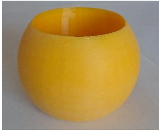
写真5： 3回目、#600で仕上げ磨きをしたところ
