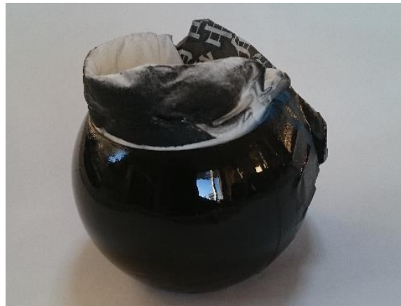
写真6： 塗装しないところを、マスキングして水性ペイントをスプレーしたところ
