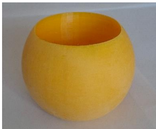
写真4： 2回目、#320で中磨きをしたところ
