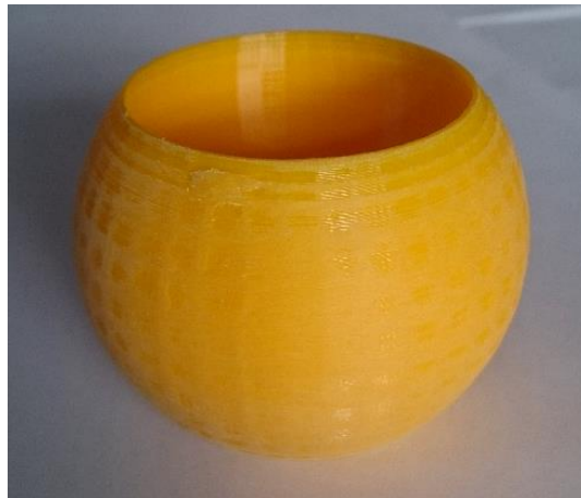
写真3： 1回目、#180で粗磨きをしたところ
