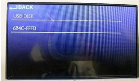
手順7：USB メモリー内部のファイルが表示されますので、前面パネルのダイヤルで本体ソフトウェアのファイルを選択し、ダイヤルを押します。
