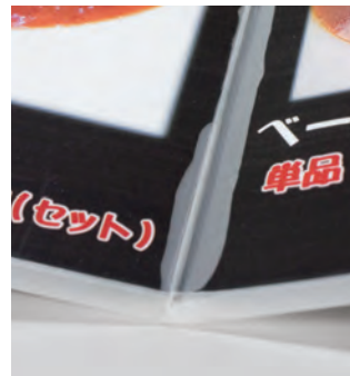
失敗例(剥がれている)
