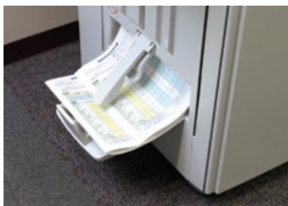
複合機本体に装着した『imagicフィニッシャーSR40V』。 丁合、仕分け、製本など面倒な後処理を自動化する。
