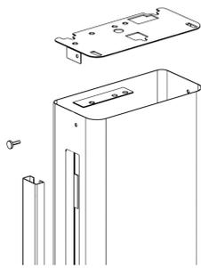
① 本体から固定金具、ネジ、配線隠し金具を外します。
