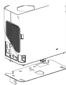
③ プロジェクター本体の位置を調整しながら固定金具を取り付けます。
