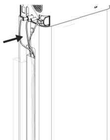
⑦ 結線を行い配線スペースにケーブル類を収納し、配線隠し金具を装着します。
