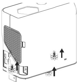
④ 固定金具を取り付けた後アジャスターを三箇所締めこみしっかり固定します。
