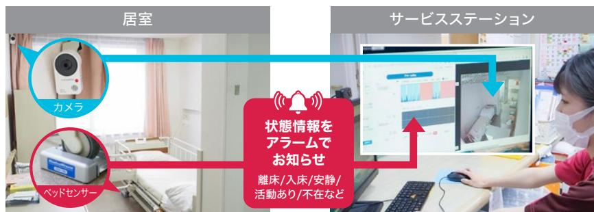
ベッドの脚部に設置したベッドセンサーが、入所者の動きを検知しアラームでお知らせ。サービスステーションでみまもりカメラの映像を確認しながら、必要に応じた対応を行う。
