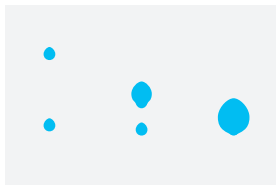
布地へ到達する前にインク滴を空中で1つにする技術で3種類のインク滴を形成。
