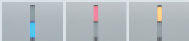
青(点灯)：印刷中 青(点滅)：原稿の読み取り中
