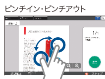
2本の指でタッチし、指の間隔を広げたり狭めたりすることで画面表示の大きさを変えます。
