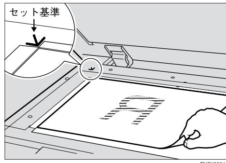
この方向でセットしたときは、一般に、送信時に原稿セット方向の設定を変更する必要があります。⇒ P.82 「原稿の片面だけを読み取る場合」
