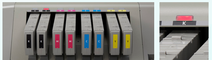
LED状態表示 無点灯：使用可能インク 赤点滅：インク残量わずか(インクニアンド) 赤点灯：インク切れ(インクエンド)
